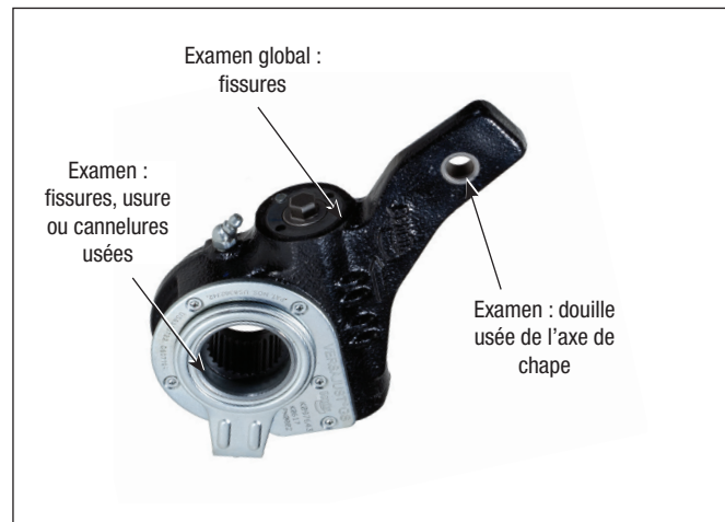
Figure 41 – Vérification du réglageur de jeu automatique
