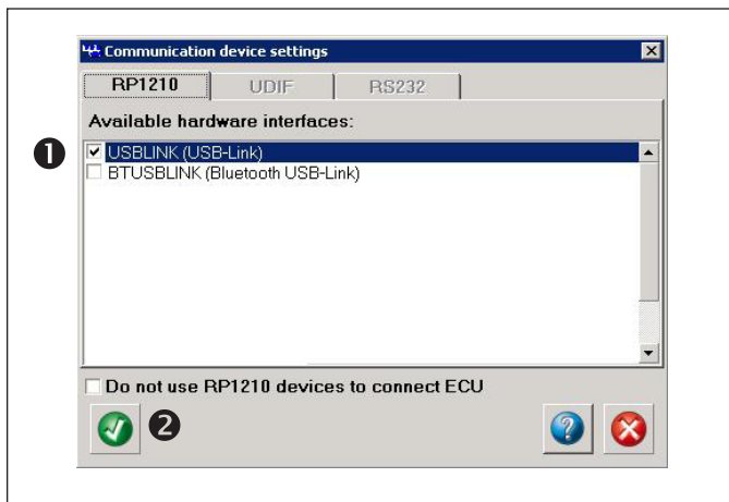
Imagen 8: software de diagnóstico ACom de Bendix; pantalla de interfaz del hardware
