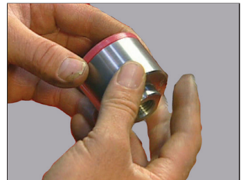
Figura 83 – Coloque el tubo de guía nuevo en la herramienta de instalación de manguitos (T07)
