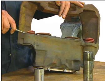
Figura 69 – Retire los anillos de seguridad, los pasadores guía y los tubos de guía
