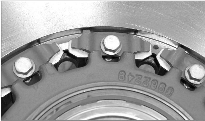
Figura 92 – Tornillos pasadores instalados
