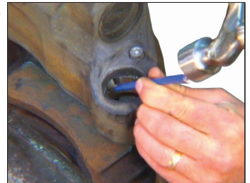
Figura 74 – Retire la pestaña que sostiene el casquillo en su posición
