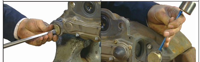
Figura 66 – Apalanque para quitar la tapa del pasador guía (10)
