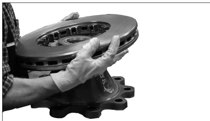
Figura 89 – Instalación del rotor
