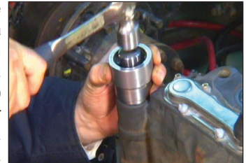
Figura 86 – Los tubos de guía deben comprimirse completamente durante la instalación de la tapa
