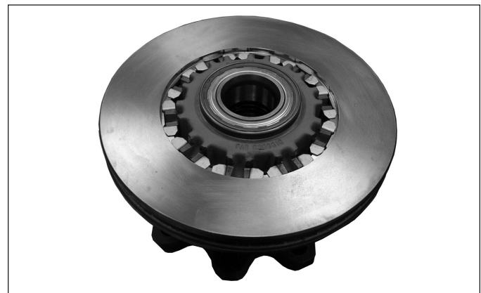
Figura 91 – Elementos intermedios (espaciadores instalados)
