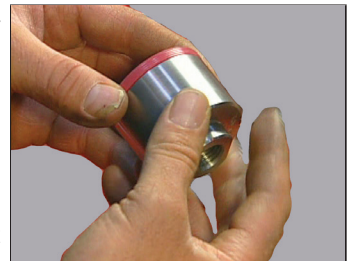
Figure 83 – Placer le soufflet neuf dans le manchon de pose (T07)
