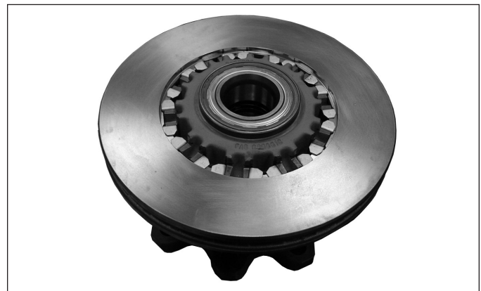
Figure 91 – Éléments intermédiaires (entretoises posées)
