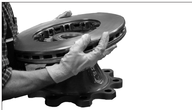
Figure 89 – Pose du disque
