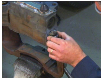
Figure 79 – Positionnement de la douille neuve
