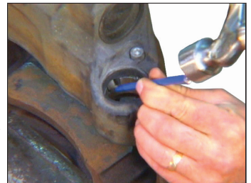
Figure 74 – Enlever la patte qui maintient en place la douille
