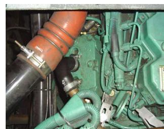
Vérifier que la conduite d'admission du compresseur ne présente ni détérioration ni déchirure
