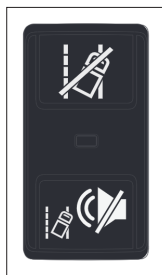
Figura 19: LDW, HDW e interruptor de desactivación de HDB
