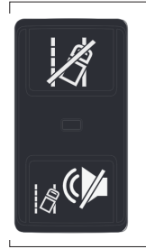
Figura 25: LDW, HDW e interruptor de desactivación de HDB
