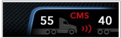
Figura 9b: Alerta del sistema AEB y posible frenado autónomo aplicado.
