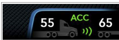
Figura 5a: ACB activada y manteniendo la distancia de seguimiento establecida
