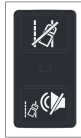
Figura 16: LDW, HDW e interruptor de desactivación de HDB
