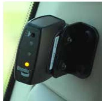
Jaune = Système actif, aucun objet détectable dans l'angle mort; changement de voie sans danger (le chauffeur doit s'en assurer en regardant dans son rétroviseur; il doit mettre son clignotant avant de changer de voie)
