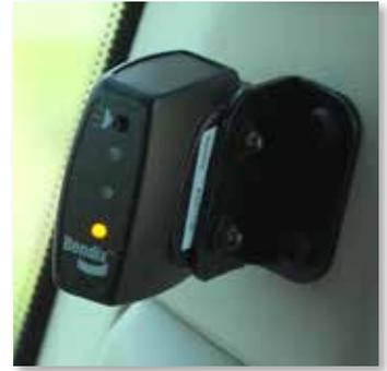
*Amarillo = El sistema está activo, no hay objetos detectables en el ángulo ciego, es seguro cambiar de carril (antes, el conductor debe revisar minuciosamente los espejos y activar la señal de giro del vehículo).*
