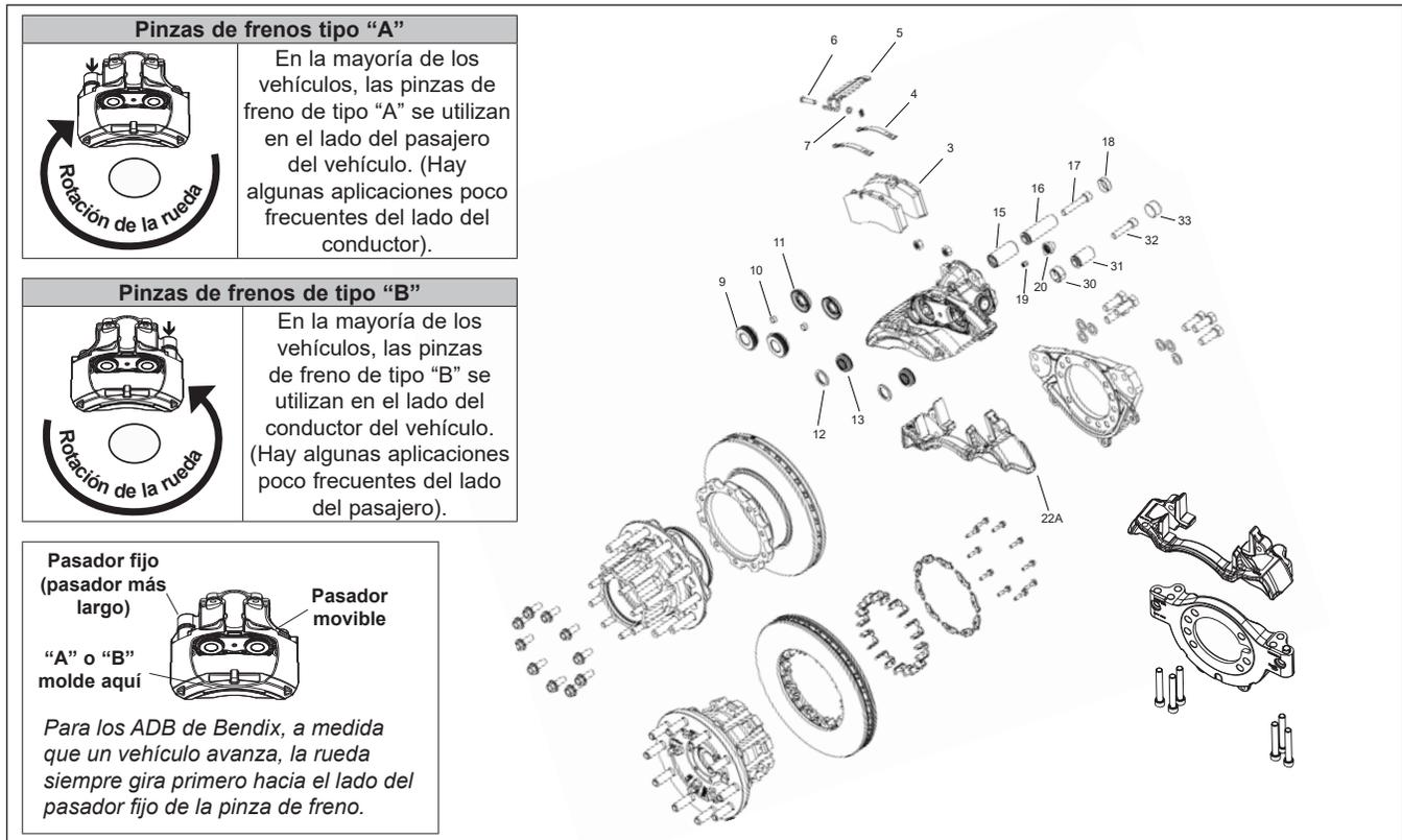
Figura 1: frenos de disco neumático (ADB) Bendix® SN-6™ y SN-7™
