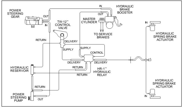
FIGURE 2 - TW-12™ CONTROL VALVE HYDRAULIC PARK SYSTEM
