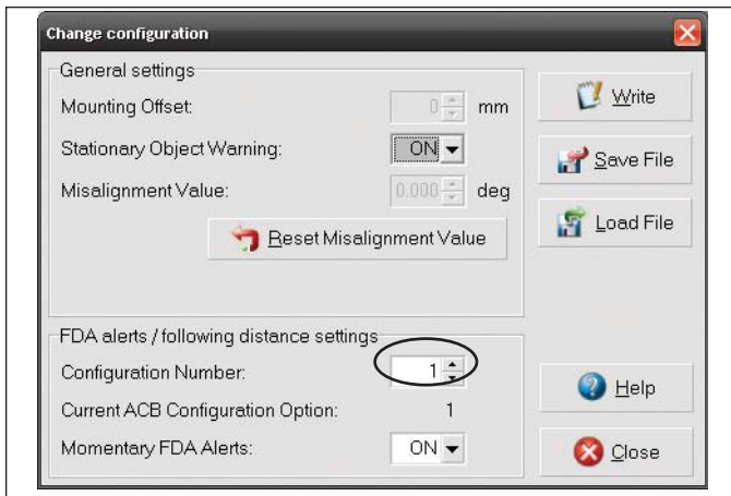
FIGURE 18 – DIAGNOSTICS ACOM® DE BENDIX® NUMÉRO DE CONFIGURATION (CONFIGURATION 1 SÉLECTIONNÉE). CF. ÉGALEMENT AU TABLEAU 8.
