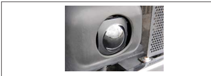
FIGURE 3 – COMPOSANT : CAPTEUR DU RADAR
