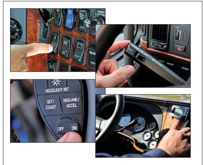
FIGURA 5 – EJEMPLOS DE LOS INTERRUPTORES DEL CONTROL DE VELOCIDAD
