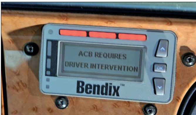
FIGURA 8 – TEXTO Y PATRÓN DE LUZ DE LA ALERTA DE IMPACTO COMO APARECE EN LA DIU DE BENDIX®
