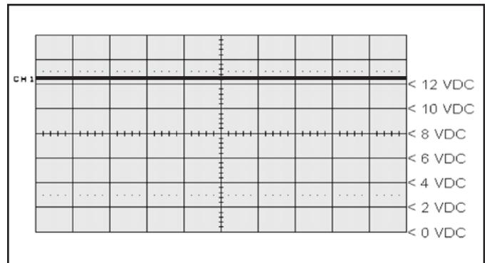
**FIGURA 4 - LINEA DE ENERGIA SIN SEÑAL PLC**
