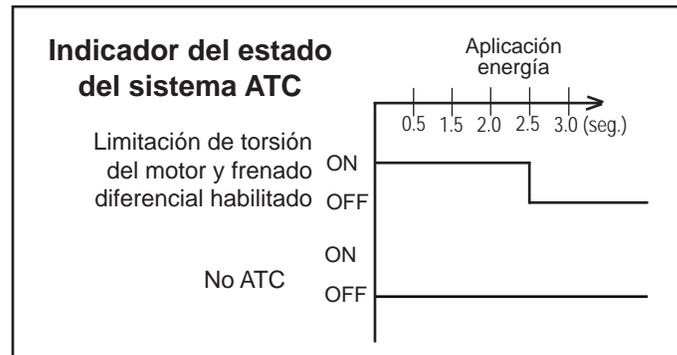
**FIGURA 7 - SECUENCIA DE ENCENDIDO LUZ INDICADORA ATC**
