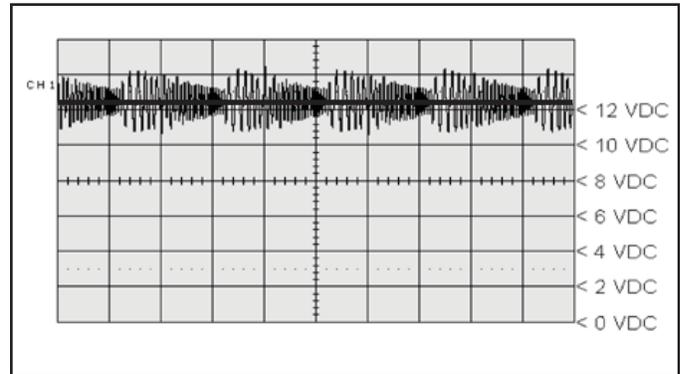
**FIGURA 5 - LINEA DE ENERGIA CON SEÑAL PLC**
