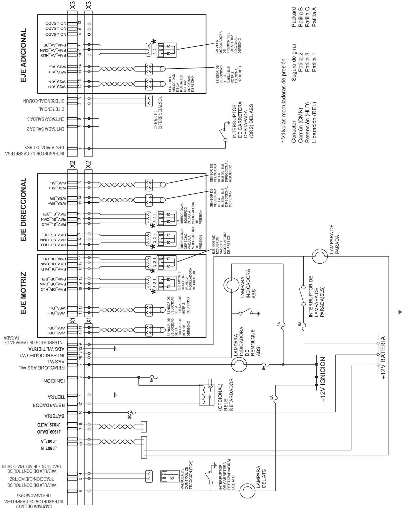
FIGURA 18 - ALAMBADO ESQUEMATICO DE CABINA PREMIUM (6S/5M)
