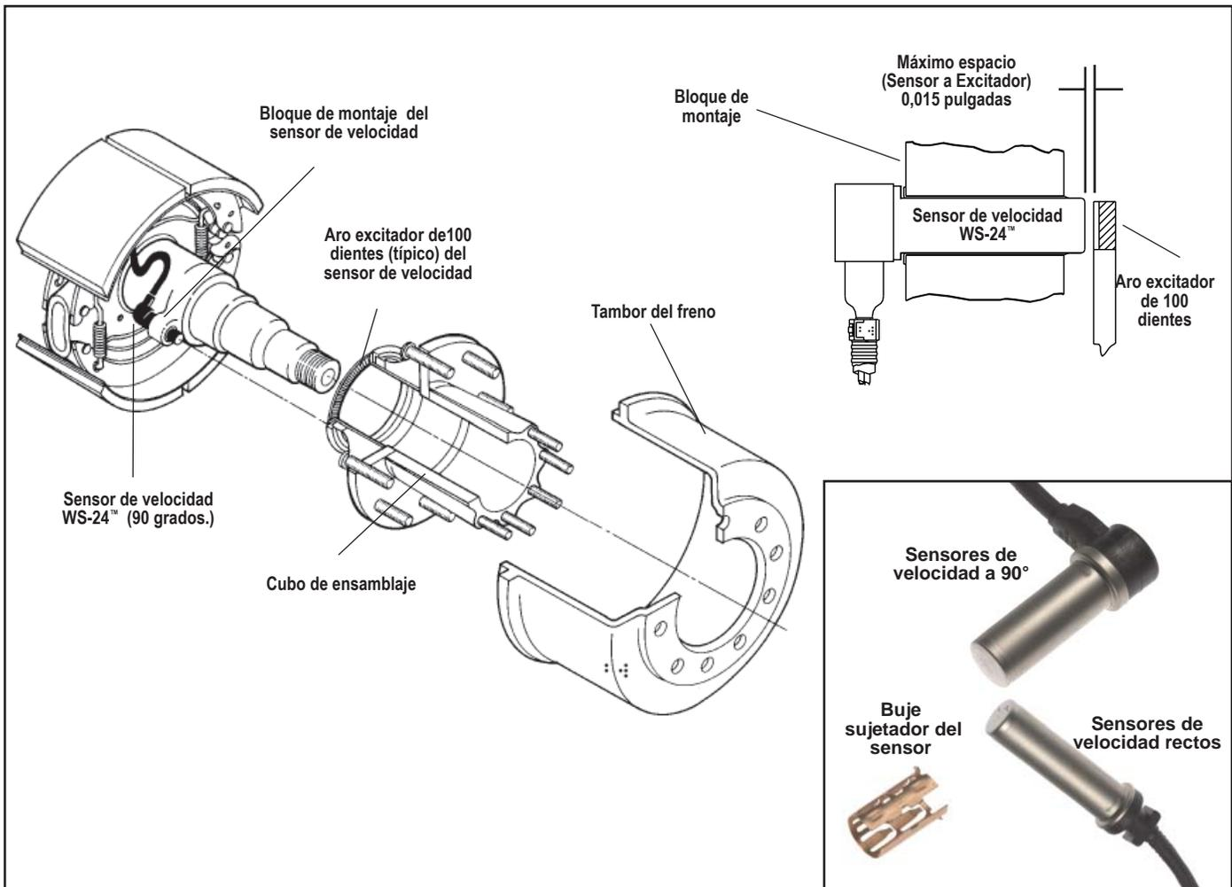
FIGURA 15 - INSTALACION DEL SENSOR DE VELOCIDAD WS-24™
