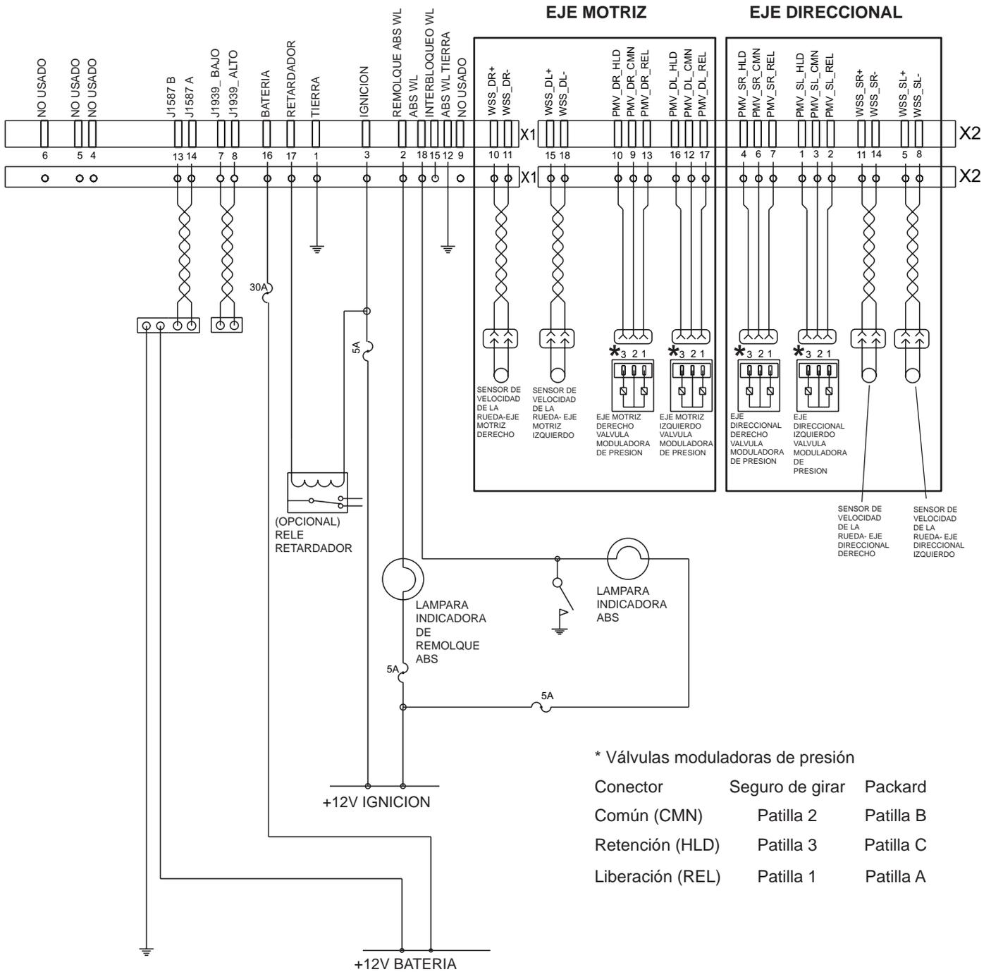
FIGURA 16 - ALAMBRADO ESQUEMATICO DE CABINA ESTÁNDAR (4S/4M)
