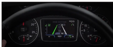
Figure 4 - Les lignes blanches de la voie indiquent que le conducteur a activé le clignotant, le LKA n'est pas activé.
