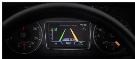
Figure 3 - Les lignes orange indiquent l'intervention de l'élément LKA.
