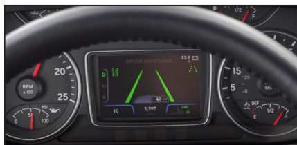
Figure 2 - Les lignes vertes indiquent que le système suit les voies et peut intervenir si nécessaire.
