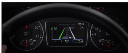
Figura 4 - Las líneas blancas del carril indican que el conductor ha activado el intermitente, el LKA no se activará.
