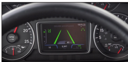
Figura 2 - Las líneas de carril verdes indican que el sistema está siguiendo los carriles y puede intervenir en caso necesario.
