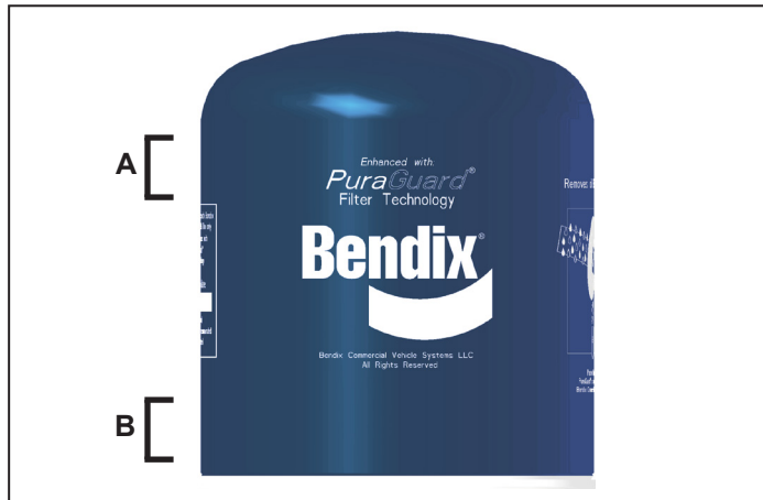
Figura 3: colocación de la llave de filtro
