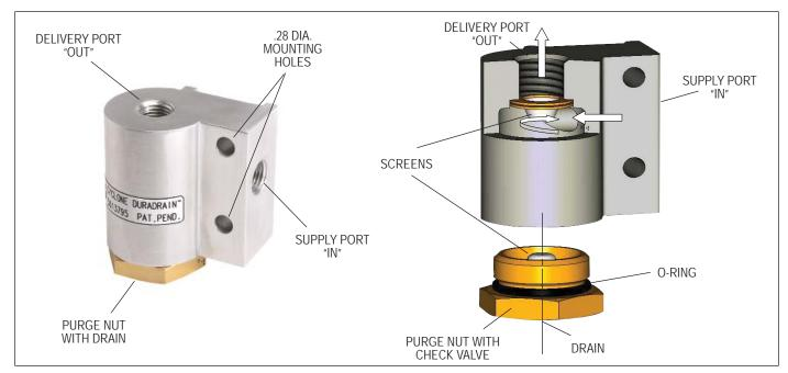
FIGURE 1 - CYCLONE DURADRAIN™ TRAILER WATER SEPARATOR
