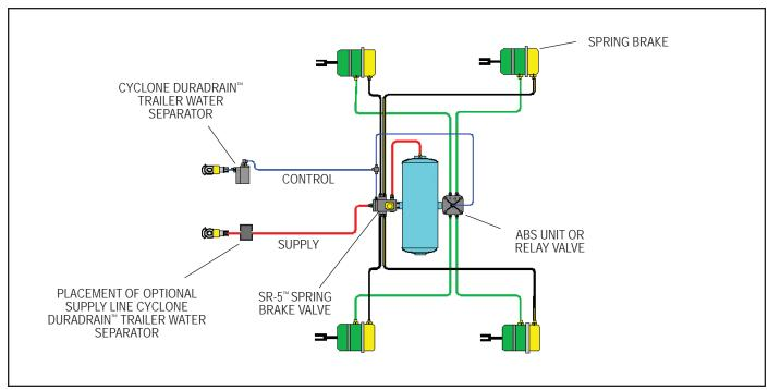
FIGURE 3 - TRAILER SCHEMATIC
