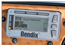
Ejemplo de la unidad de interfaz de conductor (DIU) detectado adelante Pantalla de vehículo
