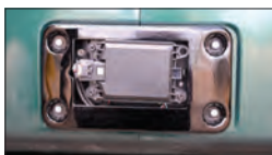
Arriba: ejemplos de sensores del radar.
