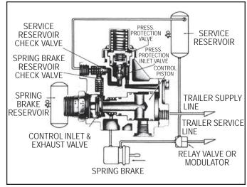
FIGURE 4 - SR-2™ TRAILER SPRING BRAKE VALVE OPTIONAL ANTI-COMPOUNDING
