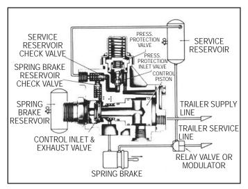
FIGURE 3 - SR-2™ TRAILER SPRING BRAKE VALVE PARK APPLICATION
