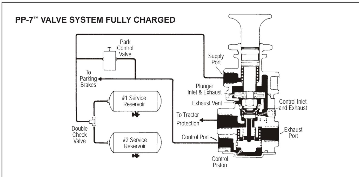
FIGURE 5 - PP-7™ TRAILER SUPPLY VALVE SYSTEM FULLY CHARGED
