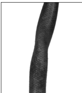
Se muestra una tubería de admisión parcialmente colapsada.
