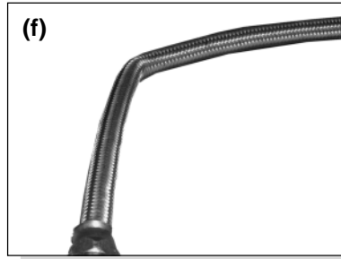
Muestra de una tubería de descarga doblada.
