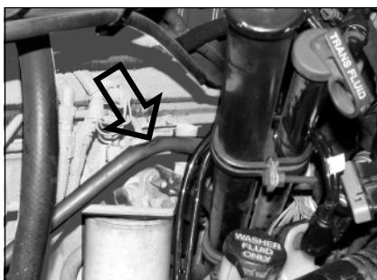
Muestra de una tubería de descarga dañada.
