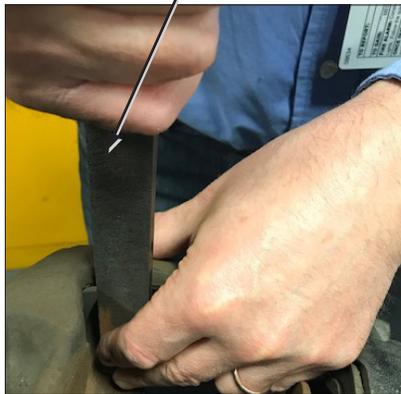
Superficie del estribo Corrosión eliminada
