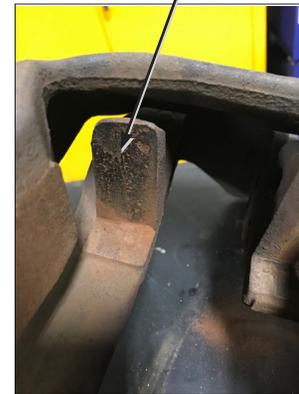
3. Inserte las pastillas en el soporte y vuelva a evaluar el ajuste.
