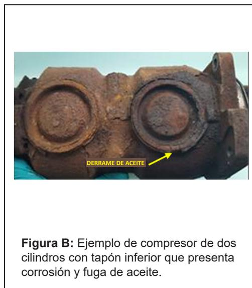
Algunos compresores de aire de uno o dos cilindros de Bendix® están diseñados con una cubierta inferior en forma de tapón (Figura A). Bendix instala el tapón para lograr el sellado y la retención deseados. El tapón no está diseñado para retirarse como un artículo de servicio. El tapón, así como todo el compresor, está tratado para resistir la corrosión, según los requisitos del fabricante del equipo original (original equipment manufacturer, OEM).
