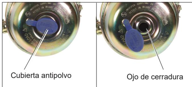
**figura 3: extracción de la cubierta antipolvo (el diseño real de la cubierta antipolvo puede variar)**
