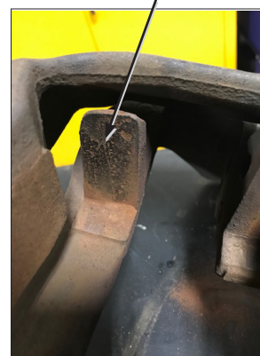
Surface d'appui débarrassée de sa rouille
