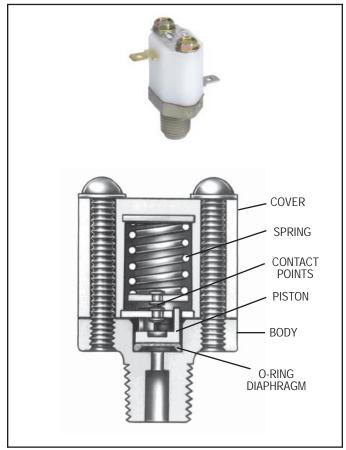
FIGURE 2 - BENDIX<sup>®</sup>LP-3<sup>™</sup> LOW PRESSURE INDICATOR
