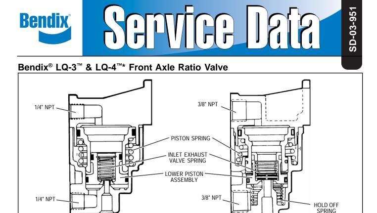
LQ-3<sup>™</sup> FRONT AXLE RATIO VALVE (\*THE LQ-4<sup>™</sup> VALVE'S OPERATION IS IDENTICAL TO THE LQ-3<sup>™</sup> VALVE. INTERNAL CONFIGURATION IS SLIGHTLY DIFFERENT.)
