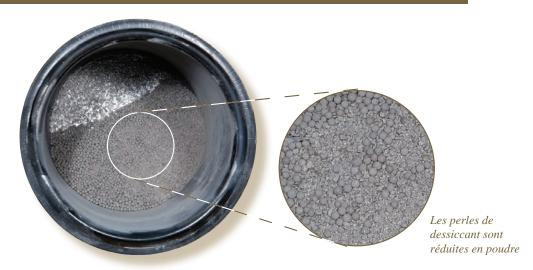
Le problème : Le dessiccant a été réduit en poudre et est imprégné d'huile Les conséquences : Une contamination qui entraîne un mauvais fonctionnement ou une défaillance des composants en aval
