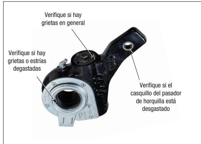
Figura 41 – Inspección del ajustador automático de holgura
