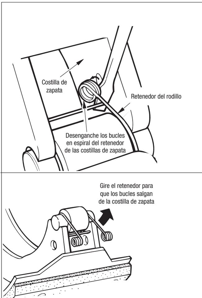
Figura 12 – Extracción del retenedor del rodillo
