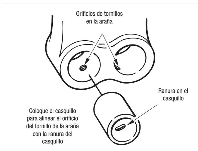
Figura 75 – Instalación de casquillo de pasador de anclaje en la araña
