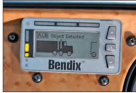
Exemple d'affichage : Alarme de créneau
