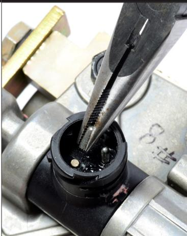
\*Otro método para romper la(s) patilla(s) es insertar cuidadosamente una broca de taladro de 13 mm (1/2 pulg.) y hacerla girar a mano (usando pinzas de presión o similar); las clavijas se romperán.
