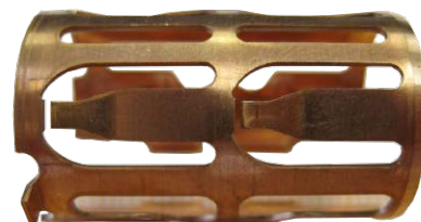
Douille de serrage en cuivre au béryllium (ancienne pièce)
