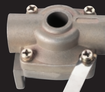
PISTON DE RELAIS E-6 CLONÉ À seulement 450 000 cycles d'endurance : pièces brisées et fissurées prématurément forte abrasion superficielle de l'alésage du piston Résultat : Alimentation imprévisible en pression primaire. Fuite significative et déséquilibre du système. Performances médiocres des freins du véhicule.
