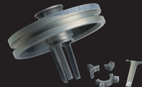
PISTON DE RELAIS E-6 CLONÉ À seulement 450 000 cycles d'endurance : pièces brisées et fissurées prématurément forte abrasion superficielle de l'alésage du piston Résultat : Alimentation imprévisible en pression primaire. Fuite significative et déséquilibre du système. Performances médiocres des freins du véhicule.
