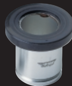
COMPOSANT DE VALVE E-6 CLONÉ À seulement 450 000 cycles d'endurance : usure de surface irrégulière excessive rayures marquées de la surface du joint Résultat : fuite d'air importante. Désalignement possible du véhicule.
