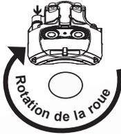
Sur la plupart des véhicules, des étriers de type A sont utilisés sur le côté passager du véhicule. (Il y a de rares applications du côté conducteur.)
