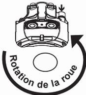
Sur la plupart des véhicules, des étriers de type B sont utilisés sur le côté conducteur du véhicule. (Il y a de rares applications du côté passager.)
