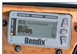
Exemple d'affichage du module d'interface chauffeur (DIU) : véhicule détecté
