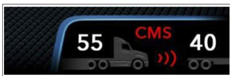
Figure 9b - Alerte du système AEB et possible freinage autonome
