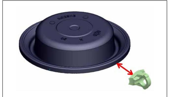
Vérifier que le joint annulaire est correctement positionné dans le corps avant à l'aide du Calibre de Contrôle de Knorr-Bremse pour contrôler la hauteur du joint.
